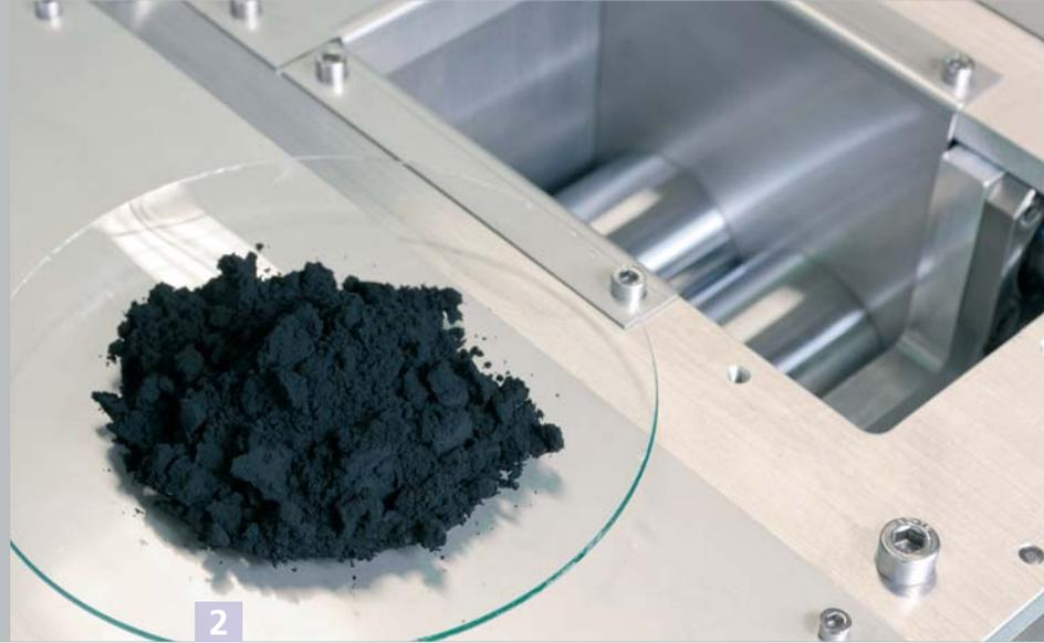
Team aus Maschinenbauingenieuren sowie Material- und Naturwissenschaftlern entwickelten die Wissenschaftler ein Gerät, das die Herstellung von Trockenfilmelektroden auf zehn Zentimetern Breite im Labormaßstab effizient und reproduzierbar ermöglicht. Das kompakte Tischgerät erlaubt zudem die Verarbeitung extrem feuchtigkeitssensibler Materialien, wie sie in Festkörperbatterien zum Einsatz kommen. Dafür lässt sich das Gerät unter Trockenluft oder sogar in Schutzgashandschuhboxen betreiben.
